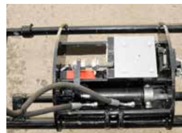
DIE ANSCHLÜSSE liegen gut geschützt im Anbaurahmen des Frontladers.
