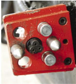
Geräteseitige Platte mit flachdichtenden Anschlüssen.
