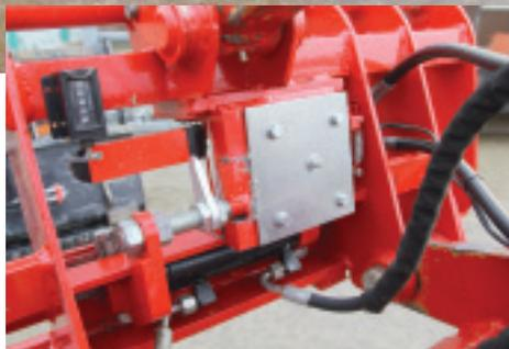
Das Schnellwechselsystem besteht aus einem Verriegelungssystem am Lader ...
