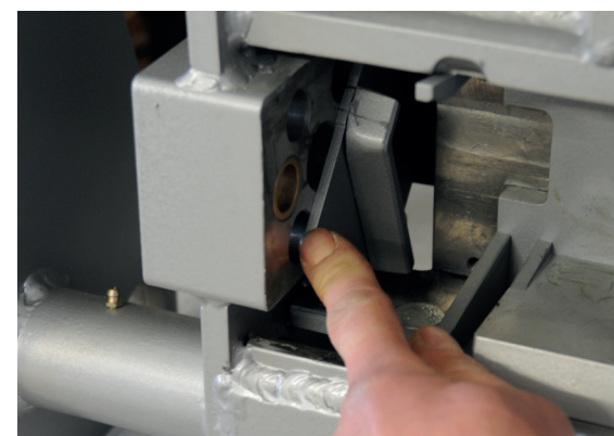
Bild links: Gleichzeitig mit der Geräteverriegelung wird die Hydraulik und die Elektrik gekuppelt. Die schwimmend gelagerte Adapterplatte an den Anbaugeräten schützt die Kupplungen vor Verschleiß.
